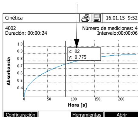
El cursor consiste de una línea vertical y de una horizontal, que se cortan en un punto de la curva. En un casillero aparecen los valores del eje x y del eje y, correspondientes a la ubicación del cursor.
