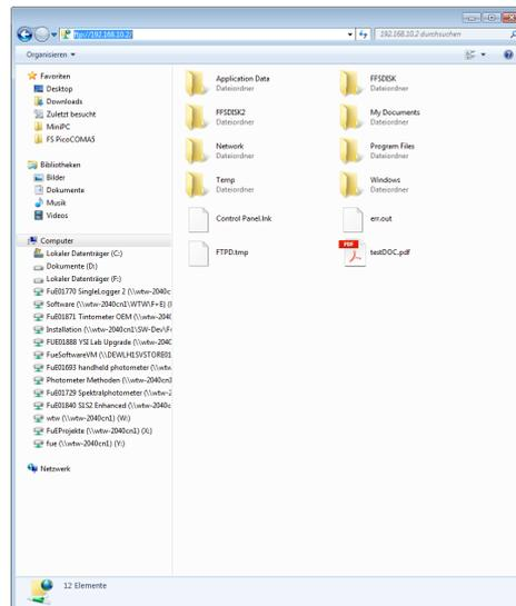
Ingresa en el Window Explorer del ordenador / computador PC `ftp://IP-address`. Aparecen las carpetas guardadas en el fotómetro.
