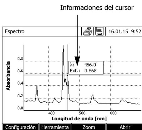
El cursor consiste de una línea vertical y de una horizontal, que se cortan en un punto de la curva. En un casillero aparecen los valores del eje x y del eje y, correspondientes a la ubicación del cursor.
