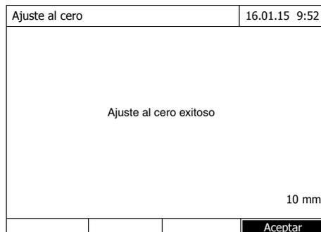
El fotómetro inicia automáticamente el ajuste cero y guarda a continuación el valor.
