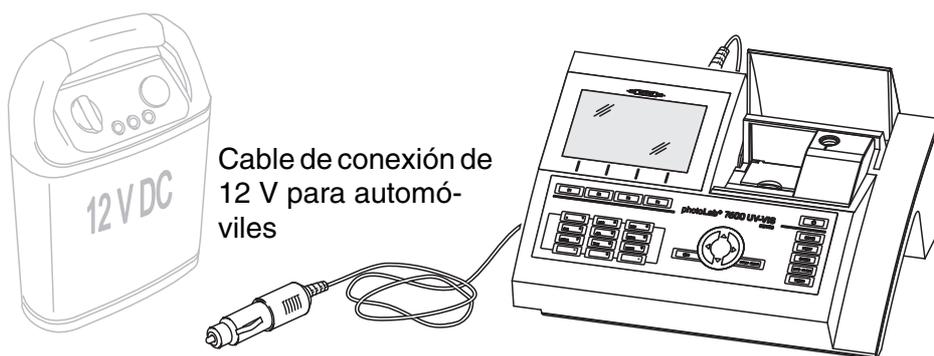
Fuente de alimentación de 12 V (por ejemplo estación energética de tipo comercial, o bien, una batería de automóvil)
