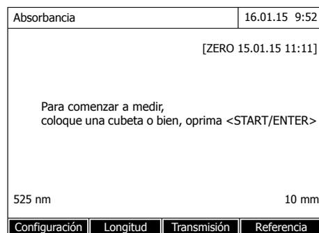
Si aún no se ha efectuado el ajuste cero, el fotómetro solicita que se efectúe el ajuste cero.
