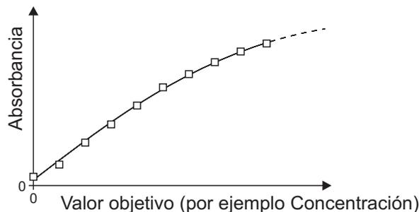
Fig. 4-3 Ejemplo de una función de calibración de parábola conforme a la calibración de 10 puntos
